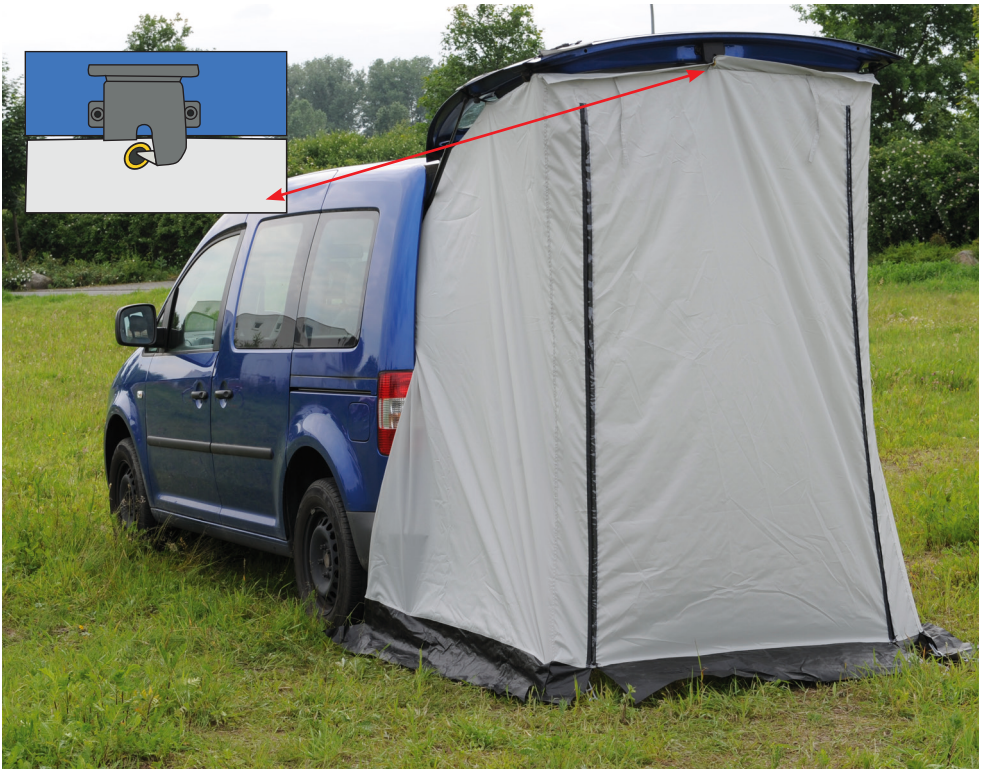
Zeltbefestigung über der Heckklappe • Tent attachment to the tailgate
